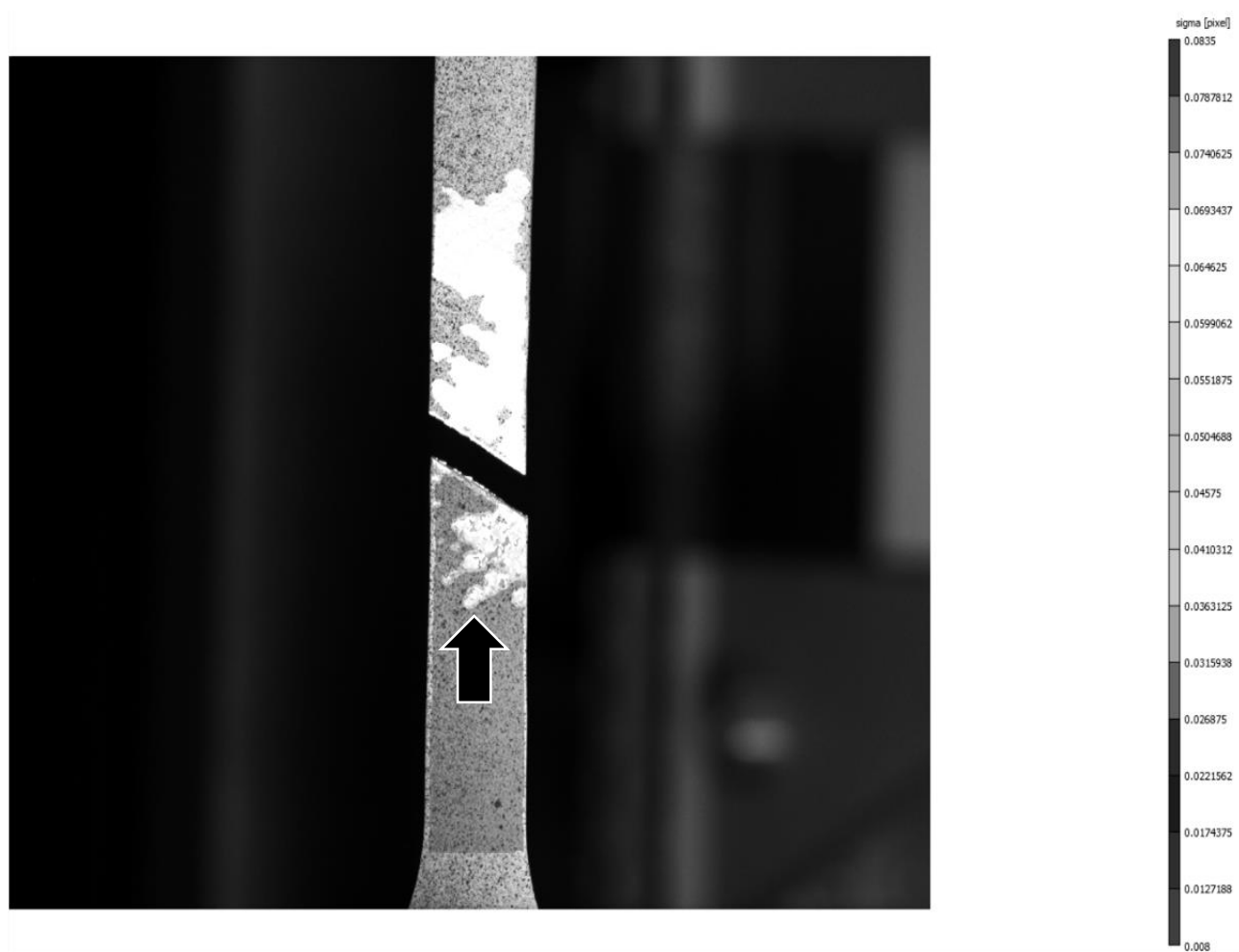
Рис. 4.7. Распределение полей деформации в образце из стали ВНС9-Ш после разрушения образца
